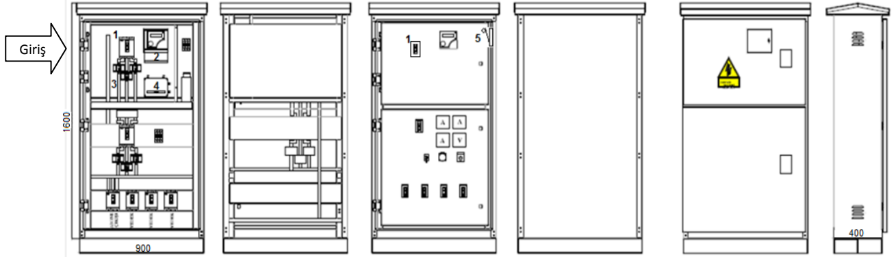
(Şekil -1) Pano Boyutları: 900X1600X400 mm
